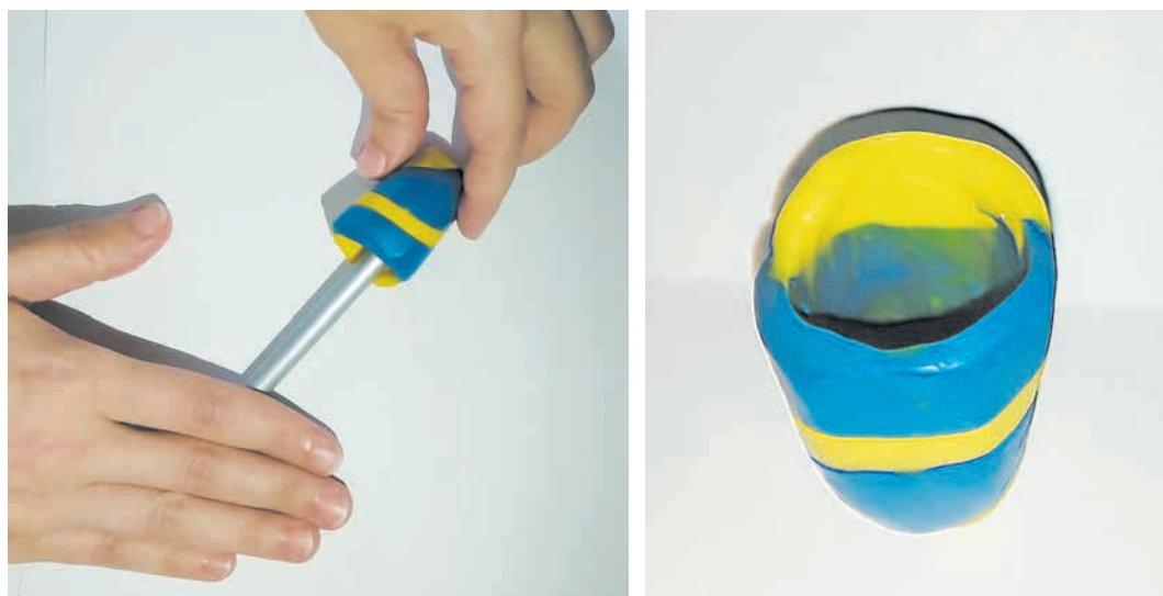
Способ формовки на основе вбивания в пластилиновую массу
